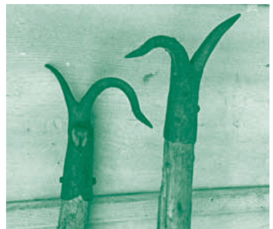
Neben dem Zapfen war der Flözhaken das wichtigste Arbeitsinstrument der Flößer. Der Haken war an einem Ende der drei bis fünf Meter langen Stangen befestigt und diente zum Ziehen und Stoßen der Baumstämme.
